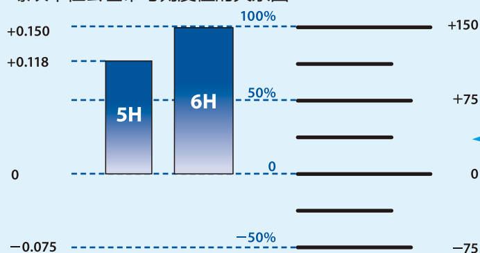
螺纹中径公差带与刻度值的关系图
