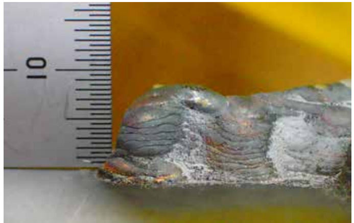
图3. SKD11(60 HRC)材料通过DED方法沉积的照片
