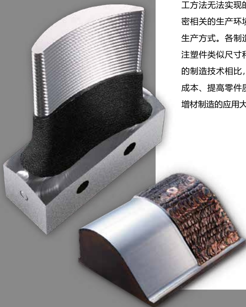
AM-EBT和AM-CRE专为增材制造应用和零件焊接部的粗加工设计。
