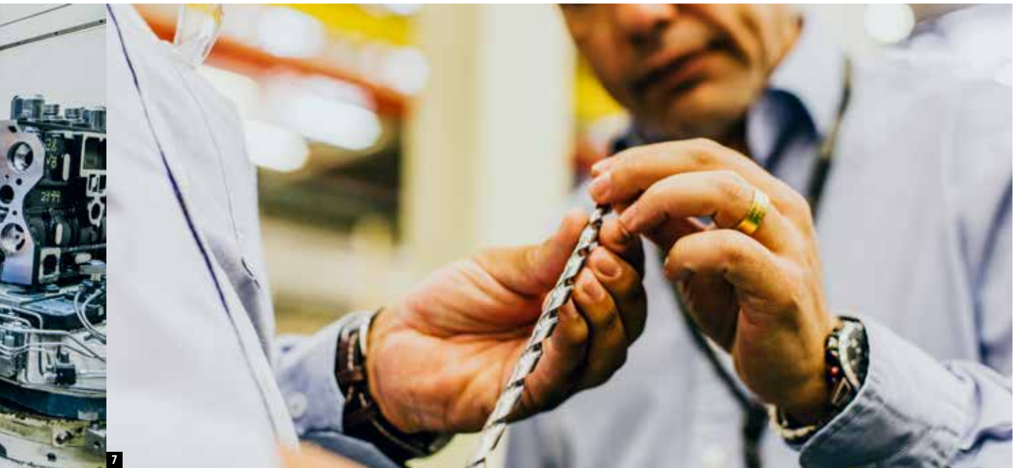
7. MWM工程师Tarcisio Bottaccini在查看直径8毫米直径的ADO-30D高性能硬质合金钻头。
