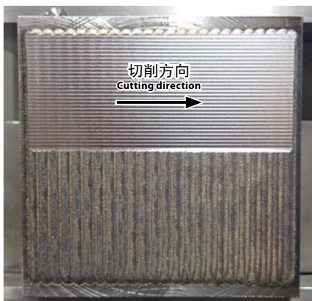
使用大隈株式会社的LASER EX进行建模 Molded using the LASER EX by Okuma Corporation
