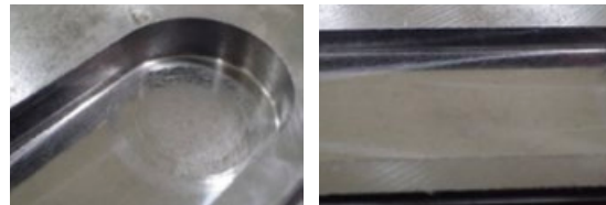
钻铣 → 横向加工 Plunging Horizontal Milling
