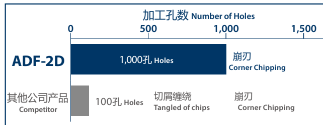
加工100孔后的比较 Comparison after processing 100 holes
